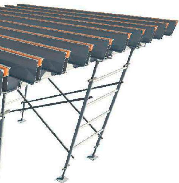
ISOMETRICA SOPORTE DE LOSA HI-LOAD
